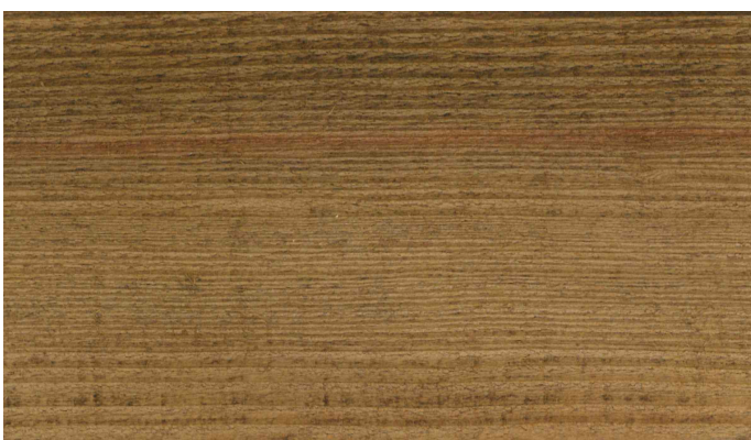
Holzschalung, Weisstanne Druckimprägniert und geölt
