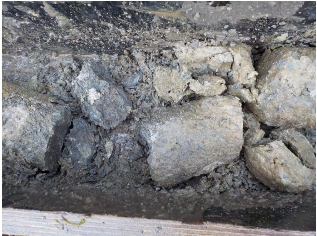
Abbildung 3: brüchiger, kohligter Mergel aus KB 13-24 (ca. bei 15 m Tiefe)
