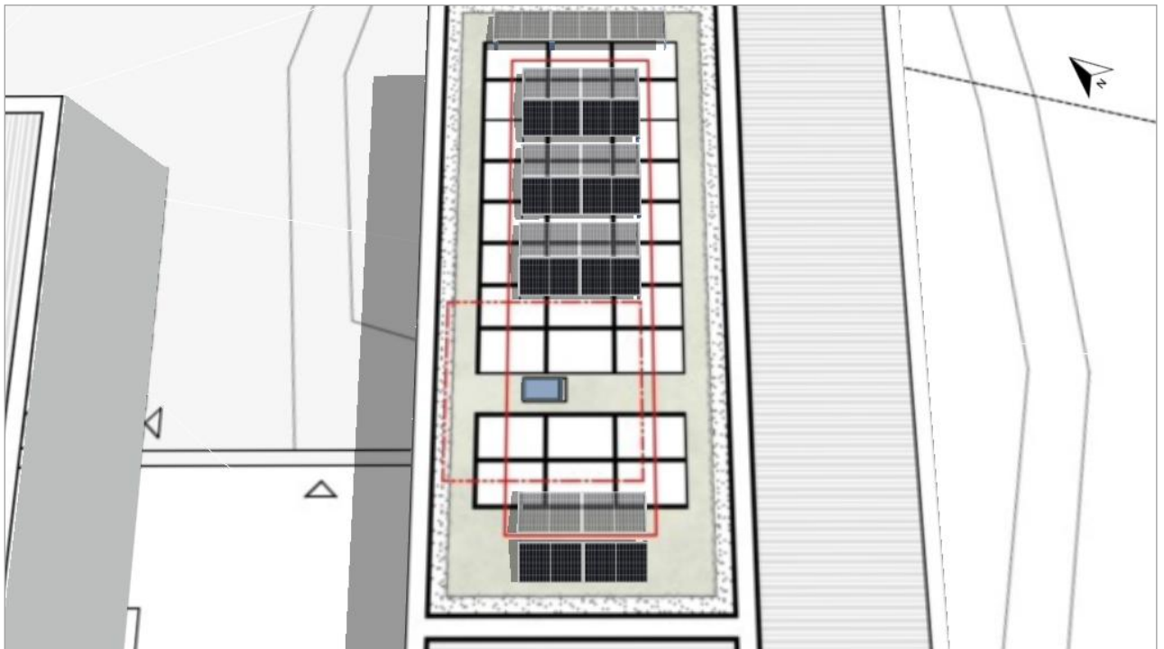
Abbildung: 8. Modulfläche - Beliebiges 3D-Objekt 01-Modulfläche Südwest
