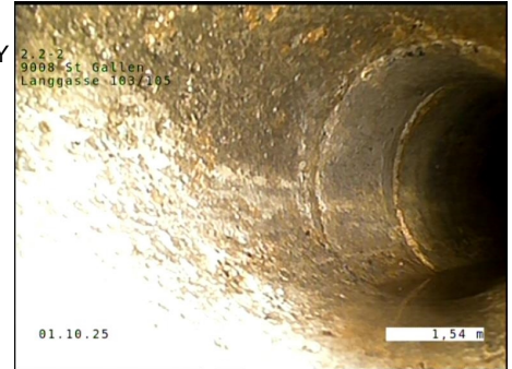
Pos: 3; Bogen nach rechts, Winkel = 30°
