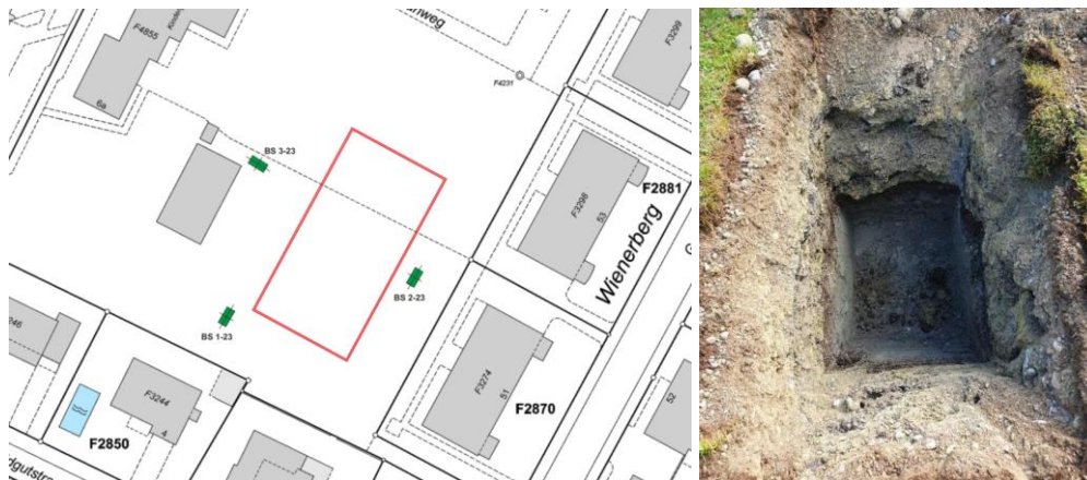
Baugrunduntersuchungen: Lage Baggerschlitzte
